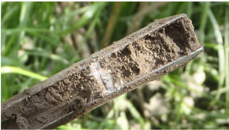
Figuur 2.4: Opmeting van een Marker Horizon met behulp van een witte kaolienkleilaag.
