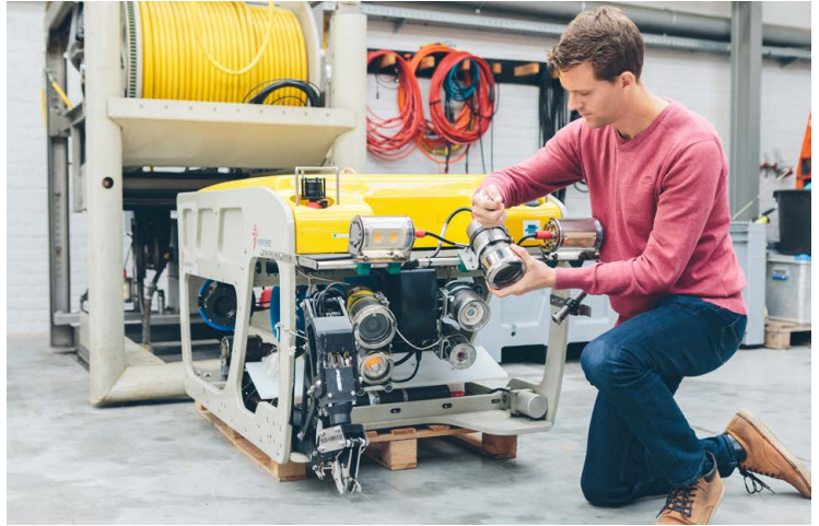
De ROV 'Zonnebloem' van het VLIZ, is uitgerust met lasers, camera's, sonars, een grijpparm en vaart met een precisie van een paar centimeter tot op 1300 meter diepte. © VLIZ (Decombel)
