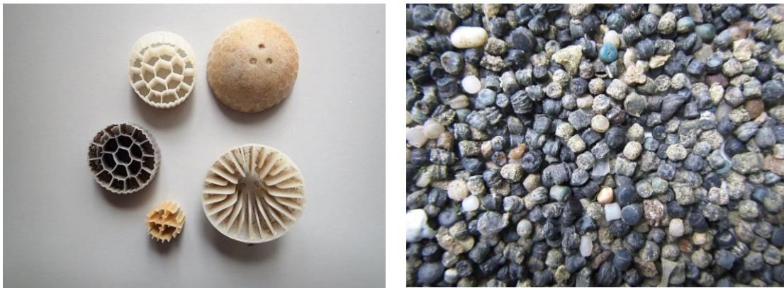
Figuur 2: Biomedica: Camenberts en Picobells (links) en Biobeds (rechts) gebruikt voor de zuivering van afvalwater in filterinstallaties (Copyright: Francis Kerckhof; Francis Kerckhof, 2019 ).
