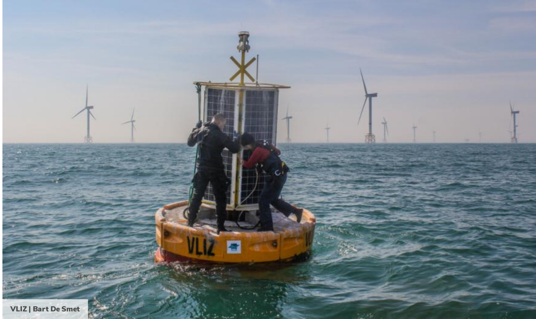
De ICOS-metboei ter hoogte van het windpark op de Thorntonbank vergt regelmatig onderhoud, onder meer om de aangroei van allerlei zeedieren van het sensorfame te verwijderen.
