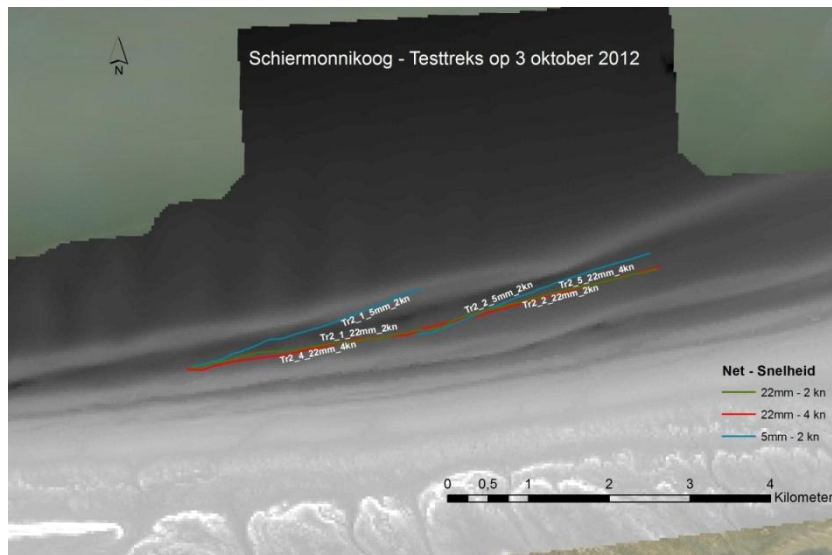
Figuur 5: Treklogs van testtrekken op 3 oktober 2012 met 22 mm net aan verschillende snelheden (groen = 2 knopen over de grond; rood = 4 knopen over de grond) en met 10 mm (blauw) net in het referentiegebied Schiermonnikoog.
