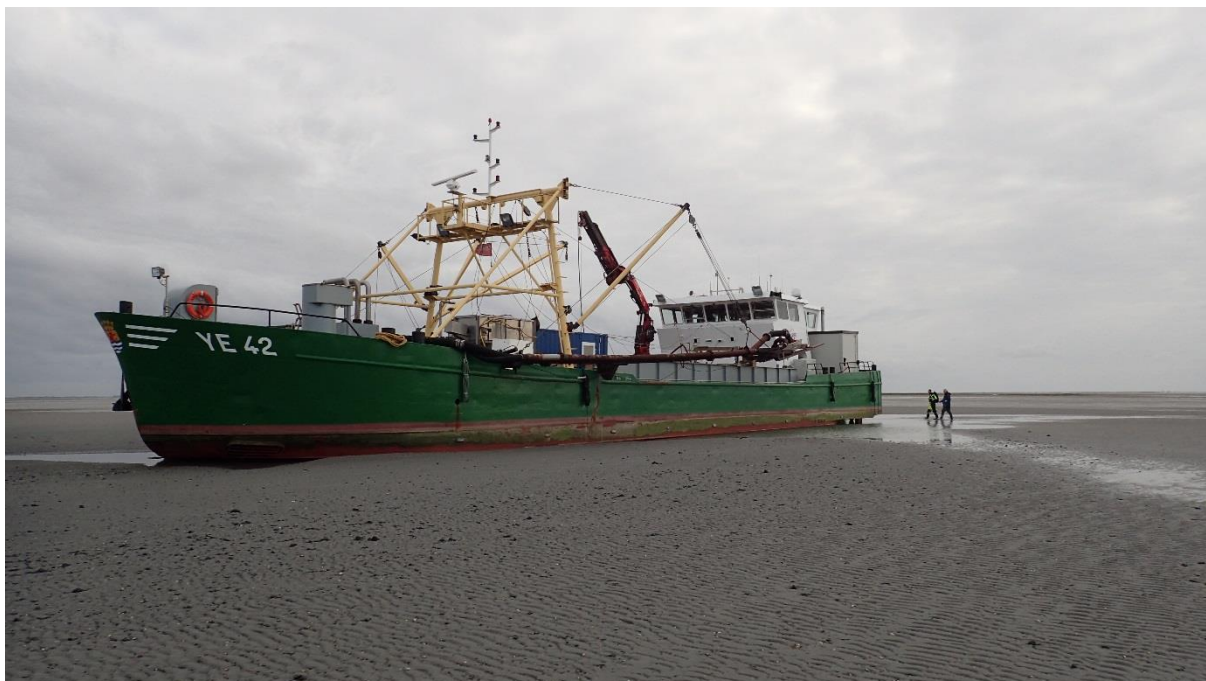
Figuur 6: Het onderzoeksschip de YE42 drooggevalen op een Wad plaat. Aan de bakboordkant van het schip hangt in de giek een zuigbuis met daaraan de stempelkor.
