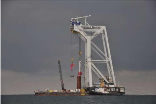
*Figure 2.70. Le battage des pieux des éoliennes offshore génère des niveaux de bruit sous-marin élevés.*
