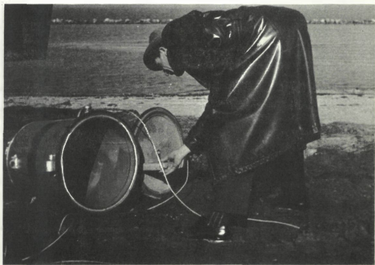
Figure 6 - La cuve vidée est soumise à un contrôle permettant de détecter les éventuels rayonnements subsistants
