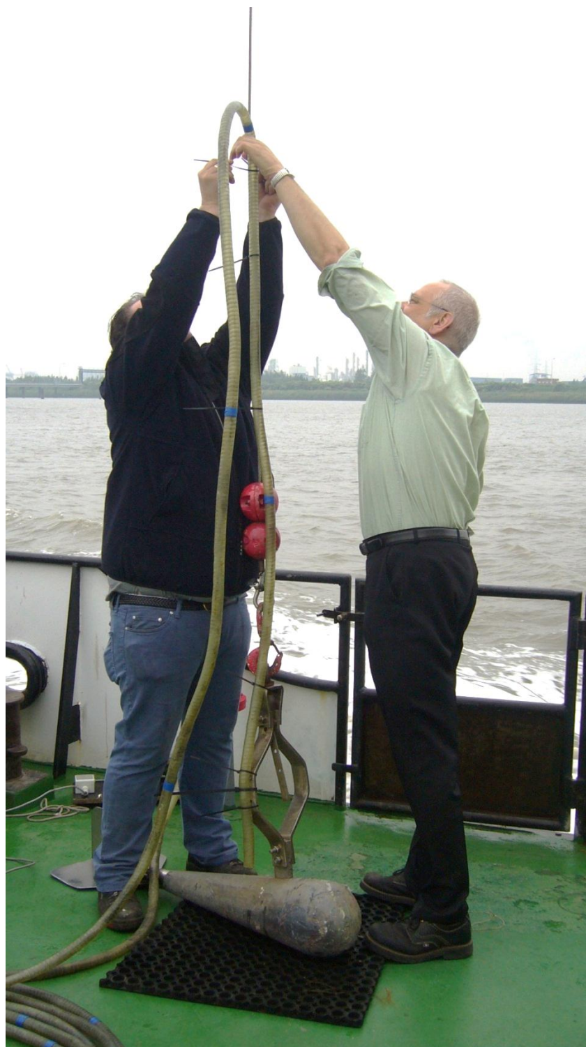
Figuur 4 – Bemonstering waterdarm vastgemaakt aan loden vis
