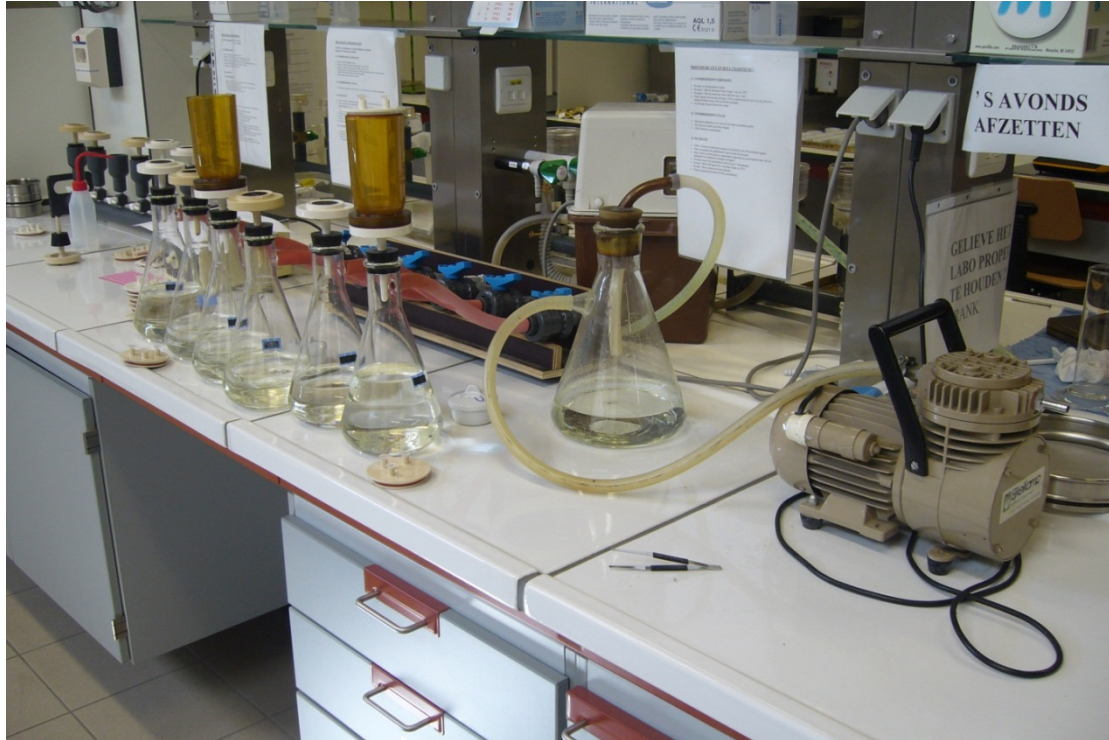
Figuur 6 – Sedimentologische laboratorium waterstalen filtratie
