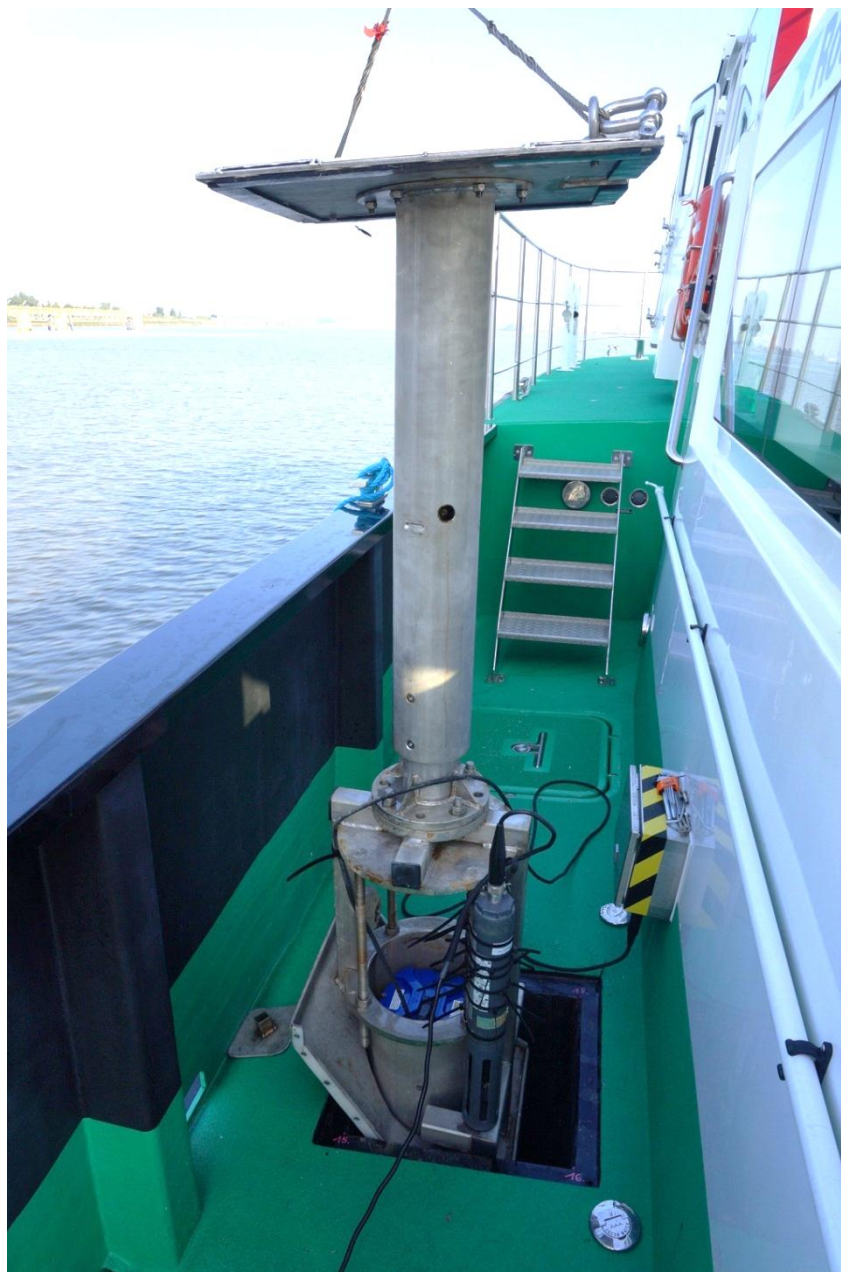
Figuur 3 – Montage Sentinel ADP in de schacht van de Pierre Petit op 01/08/2014
