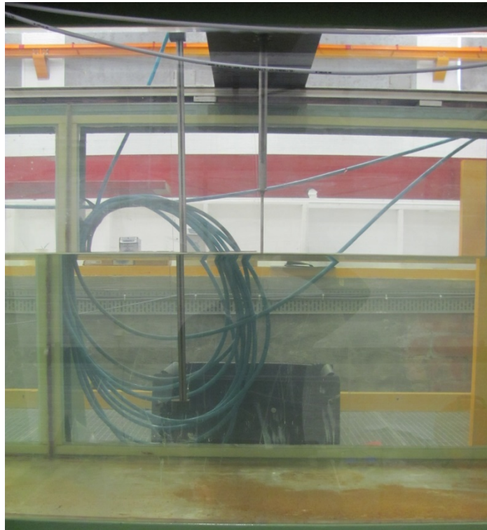
Figuur 10 – Opwaartse golvenmeter met manuele meetnaald
