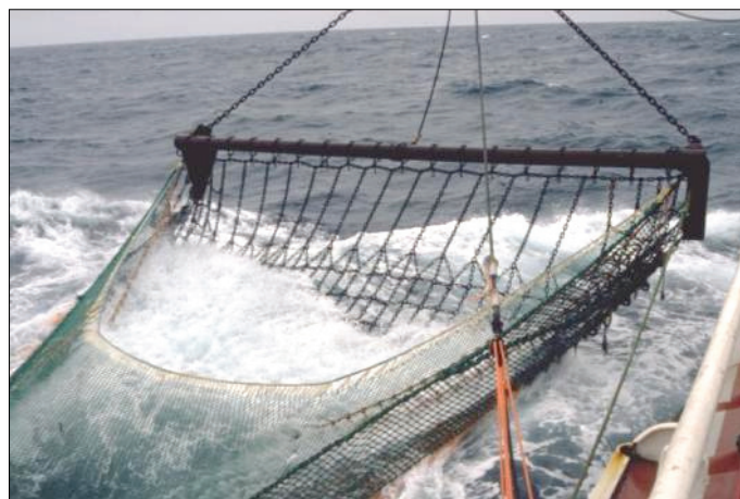
FIG. 5-2 - TERUGGESNEDEN RUG VOOR 7, 9 AND 10.5 M BOOMKORREN
