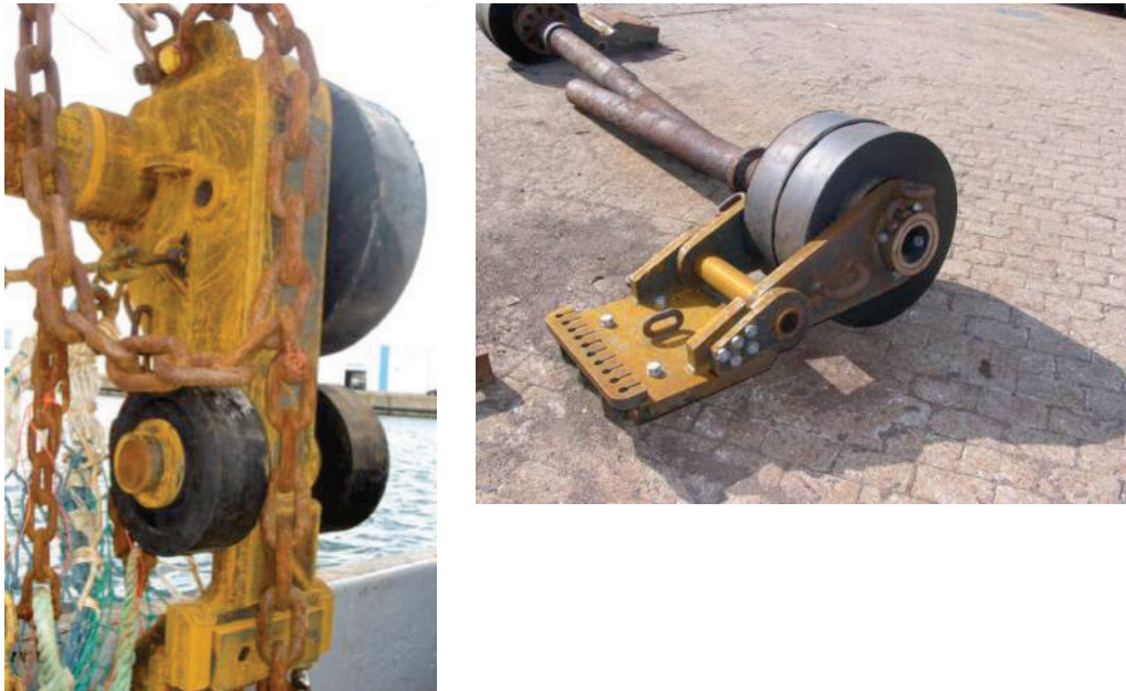
FIG. 10-1 – ROLSLOFFEN IN EEN KETTINGMATBOOMKOR (LINKS) EN EEN WEKKERTUIG (RECHTS)
