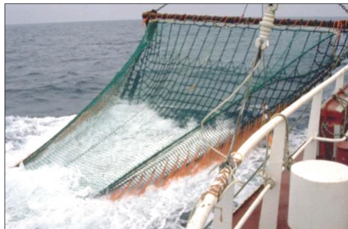
FIG. 5-1 - VIERKANTE MAZEN PANEEL VOOR 7, 9 AND 10.5 M BOOMKORREN
