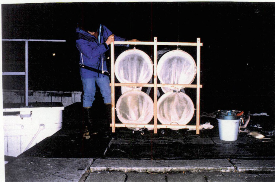
Foto 1 : Verticaal drijvend houten raamwerk met 4 hoepelnetten voor het onderzoek naar de ruimtelijke verdeling van glasaal in een watervolume.
