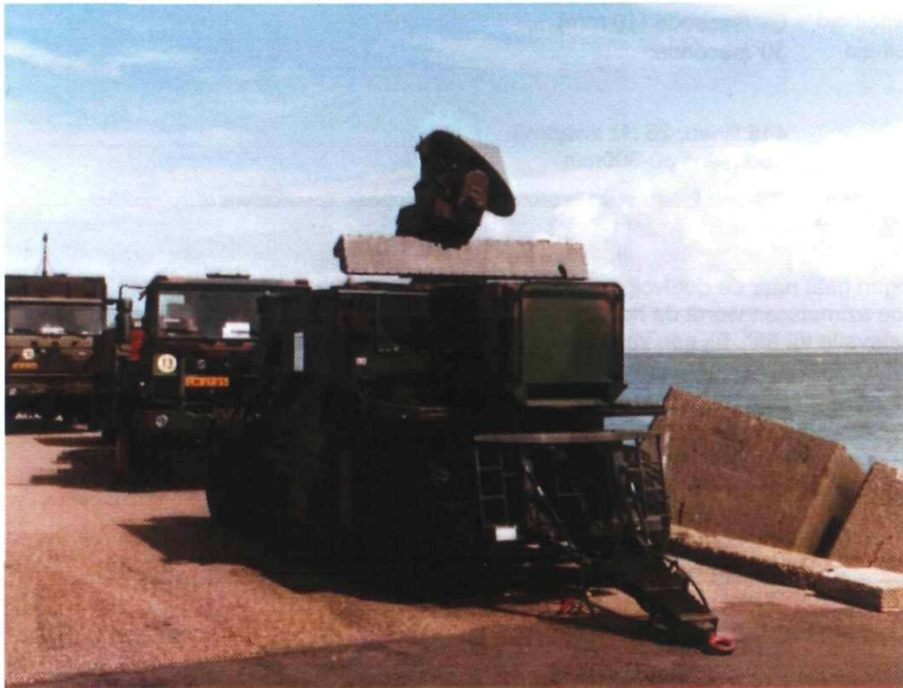
Foto 1 Flycatcher radar op de zuidpier van IJmuiden, juni 1999. De kegel bovenop de radar is de doelvolgantenne, de grote balk daaronder de zoekantenne. Flycatcher tracking radar situated on the southern pier of IJmuiden, June 1999. The cone on top is the tracking antenna, the bar underneath is the search antenna.
