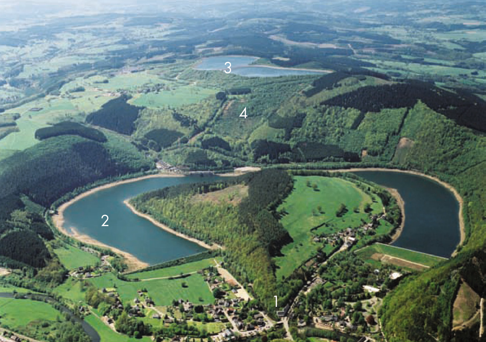
■ Op deze luchtfoto van de spaarbekkencentrale Coo-Trois-Ponts zijn te zien: 1) De watervallen van Coo; 2) Het benedenbekken (8.540.000 m 3 ) met twee dijken die de meander afsluiten van de natuurlijke loop van de Amblève; 3) De twee kunstmatige meren, aangelegd op het plateau; 4) De machinezaal met zes grote Turbo-alternatoren bevindt zich onder de grond tussen het boven- en benedenbekken (Rudy de Barse, Electrabel)
