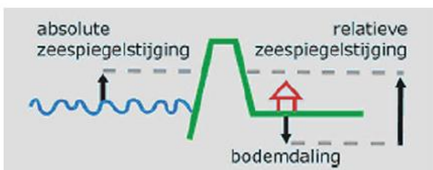
Figuur 2.26 Schematische weergave van het verschil tussen absolute en relatieve zeespiegelstijging als gevolg van bodemdaling
