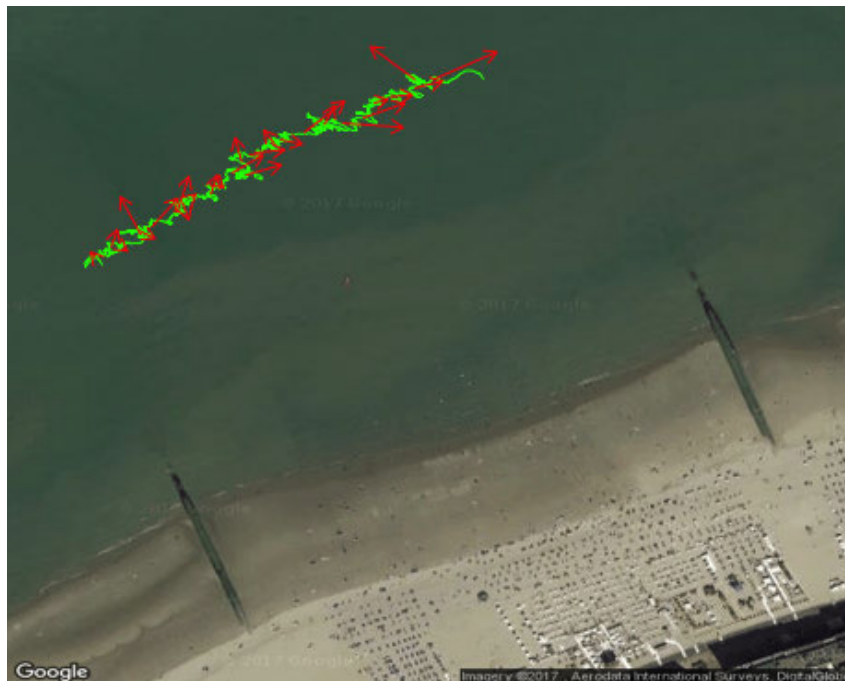
Figuur 71 Traject drifterboei tussen 09:35:57 en 10:10:57 Bron: Eigen werk
