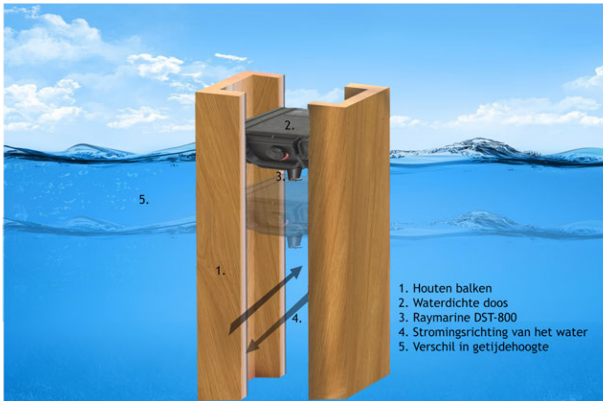
Figuur 30 Raymarine DST-800 in een waterdichte doos in een balkstructuur
