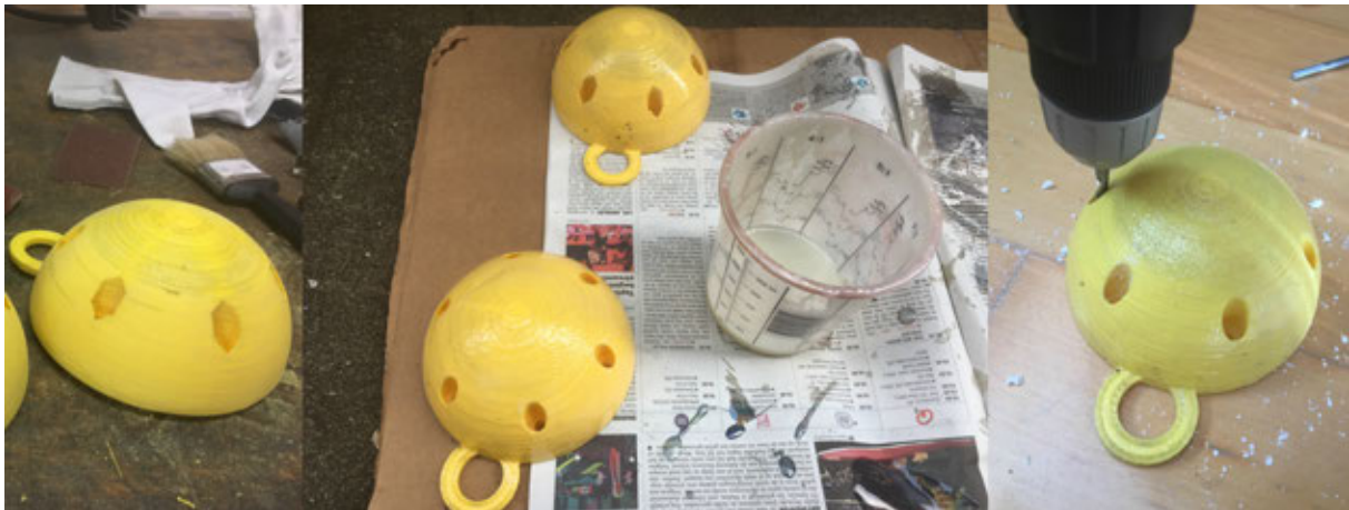
Figuur 48 Toevoeging epoxycoating prototype 3 Bron: Eigen werk
