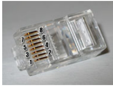
Figuur 27 Nummering RJ-45 aansluiting Bron: OpenSeaMap [48]
