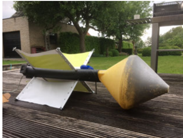
Figuur 57 Verbeterde versie ankerboei Bron: Eigen werk
