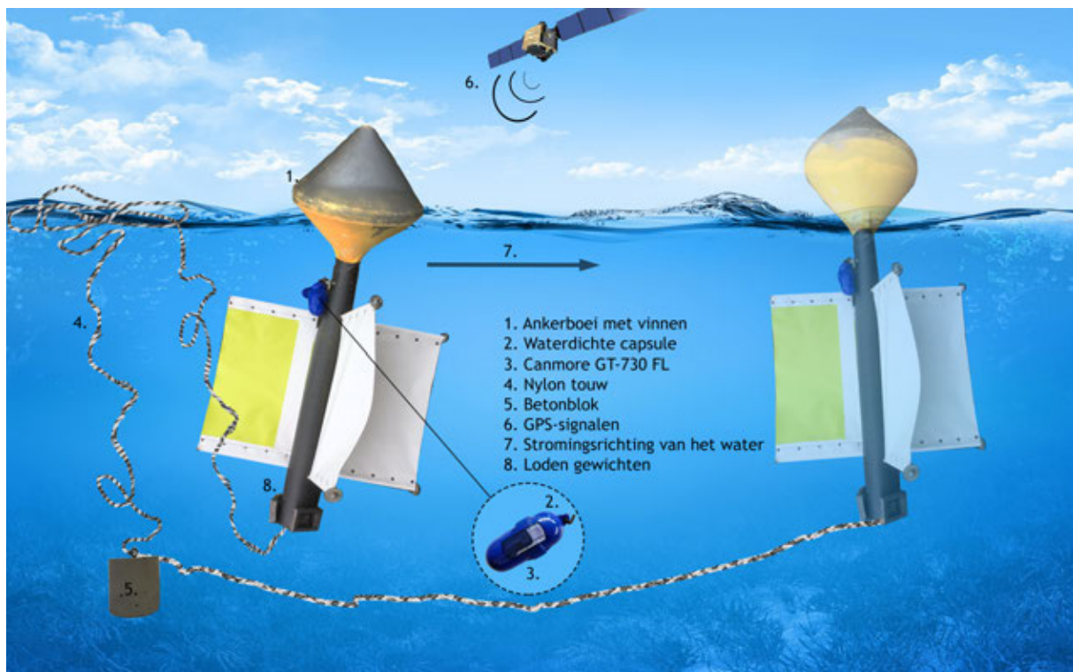
Figuur 58 Verbeterde versie ankerboei Bron: Bewerkt van Wallpaperup, Alphatec, Spaceoffice, Canmore en eigen werk. [62] [5] [44] [18]
