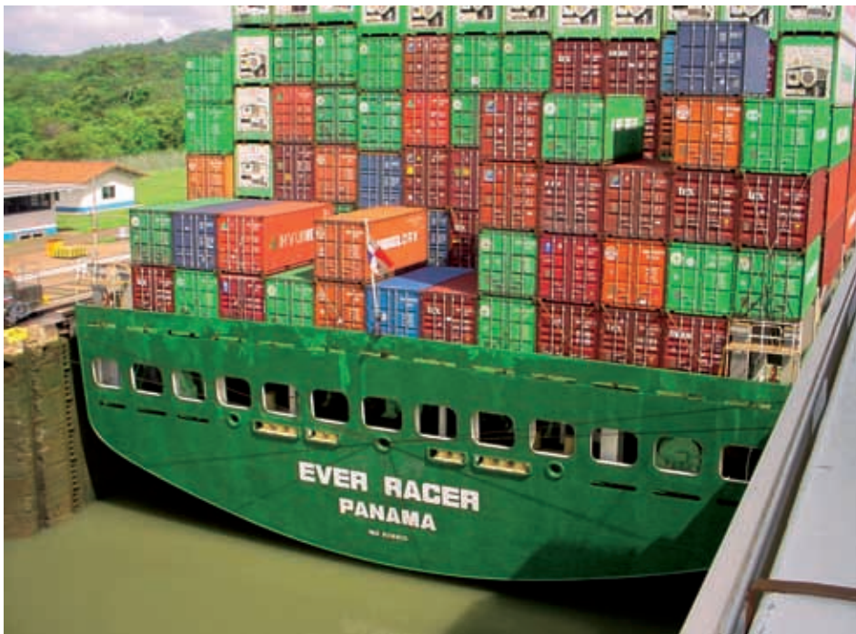
■ Sluizen zijn ontworpen voor bepaalde scheepstypes of om bepaalde combinaties van schepen in één keer te kunnen schutten. De techniek staat echter niet stil en schepen worden steeds groter. In bovenstaande foto is het containerschip Ever Racer te zien terwijl het in de Miraflores sluis (Panamakanaal) geschut wordt. De afstand tussen de romp van het schip en de wanden van de sluis kolk bedraagt aan weerszijden slechts 60 cm! Het grootste mogelijke containerschip dat in de bestaande sluizen van het Panamakanaal past, wordt een "panamax" genoemd. Het kan ongeveer 4500 twintig-voet-containers (20 Engelse voet komt overeen met een lengte van ca. 6 m) vervoeren. (T. De Mulder)
