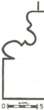
Westgevel van de abdijkerk, basisprofiel van een flankeerzuiltje (eerste helft 13e eeuw).
