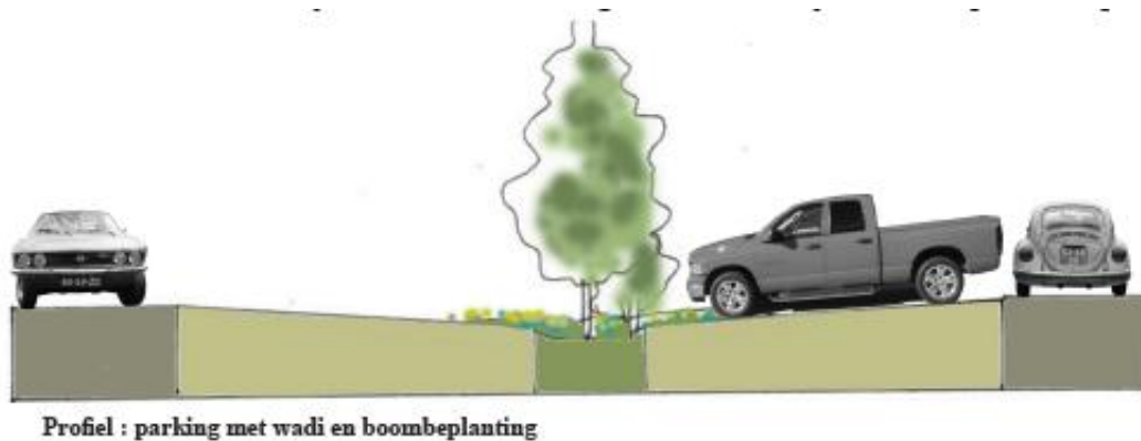
Figuur 5-4: Profiel parking met wadi en boombeplanting
