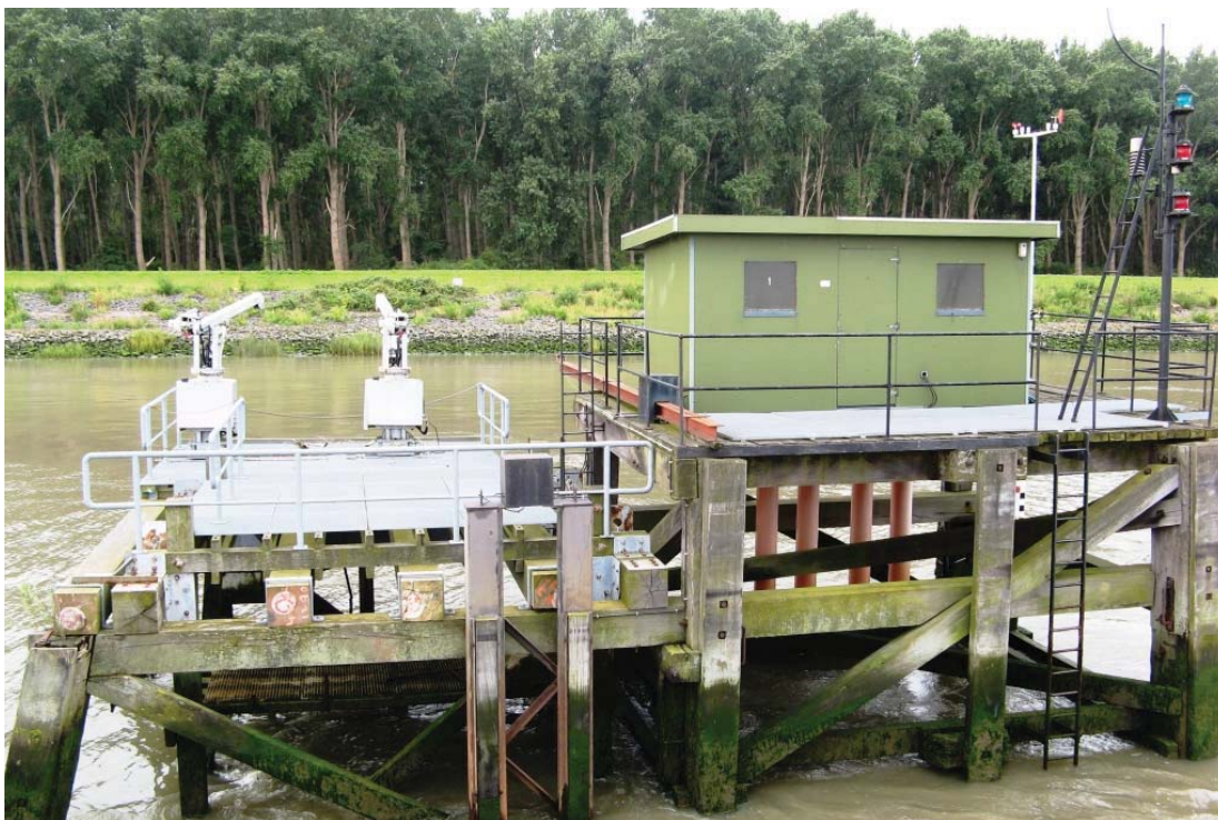
Figuur 60 - Beneden-Zeeschelde te Oosterweel: foto van de meetdukdalf met aan linkerkant (opwaartse zijde) de twee kranen elk dragend een Aanderaa-RCM9-meettoestel en aan rechterkant (afwaartse zijde van de dukdalf) de meethut met tij- en meteo-meting
