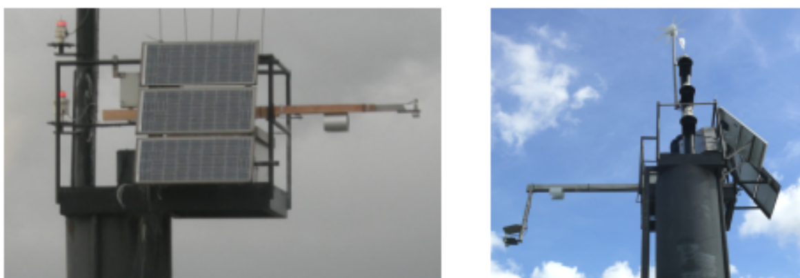
Figuur 185 - Initiële proef-opstelling van het golfmeettoestel (links) en (rechts) definitieve opstelling met o.a. windgenerator en zonnepaneel
