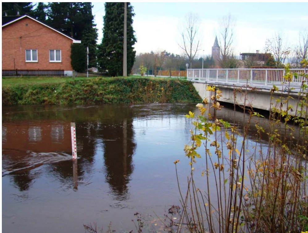
Figuur 89 - Kleine Nete te Grobbendonk (Troonstraat) : dagenlang zeer hoge waterstand bij de was van half november 2010, met het waterpeil bijna reikend tot onderkant baanbrug (ref. ing. P. Verhaegen, WenZ, afdeling Zeeschelde)
