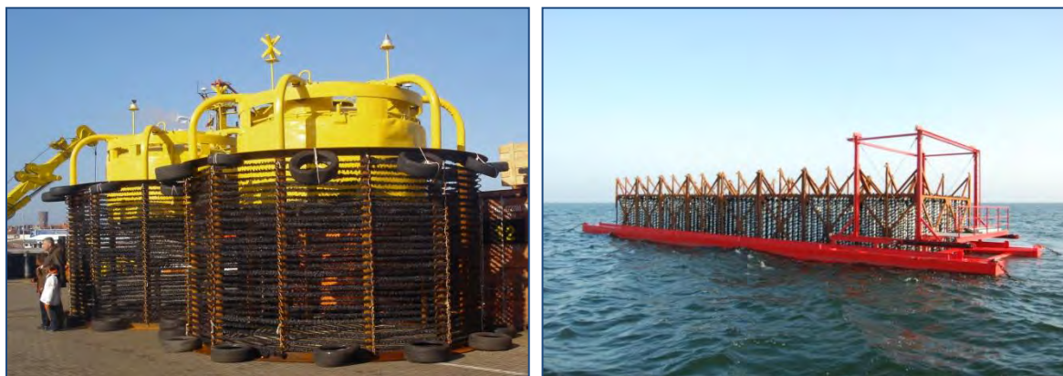
Fig. 10-22 - Twee voorbeelden van het Belgische kooisysteem voor de offshore kweek van mosselen.
