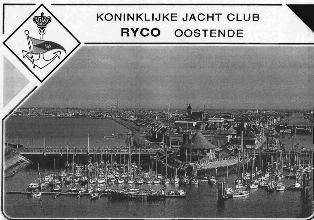
Zicht op de achterhaven ca. 1990. Op de voorgrond het jachtclubhuis RYCO. Links ervan de brug over de afgedankte spuisluis met erachter de 80 ha. grote spuikom. Rechts een deel van de voorhavenbrug met erachter de oude sluisen van Slijkens en de lijnrechte vaart naar Plassendale.
