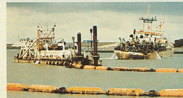
Een sleeppopperzuiger lost in zee gewonnen zand vóór een cutterzuiger die het opbaggelt en wegperst naar het strand.
