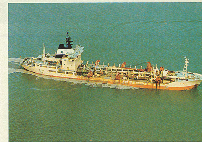
Sleeppopperzuigers baggeren de bestaande geulen naar een breedte van gemiddeld 750 meter en tot op een diepte van gemiddeld 13,5 meter onder laagwater.
