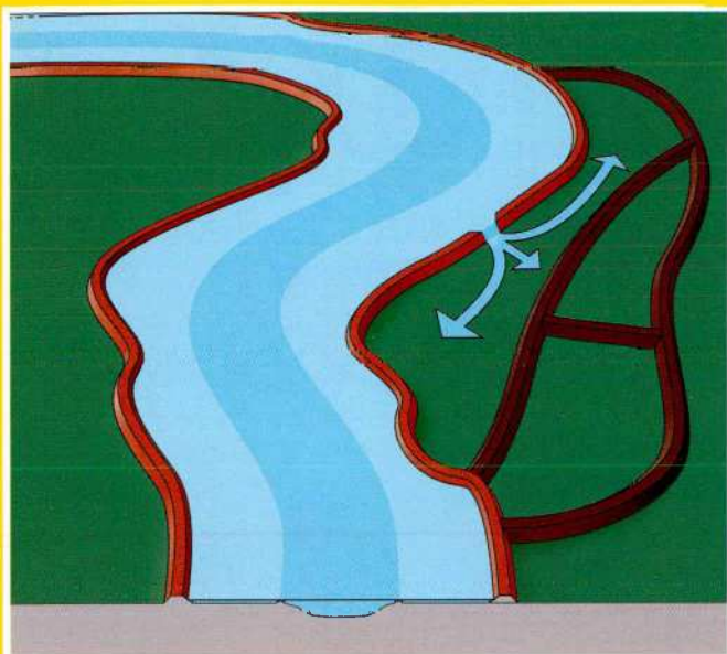
scenario 2: compartimenteren is het verder opdelen van dijkkringgebieden met binnendijken, eventueel in het hele rivierengebied
