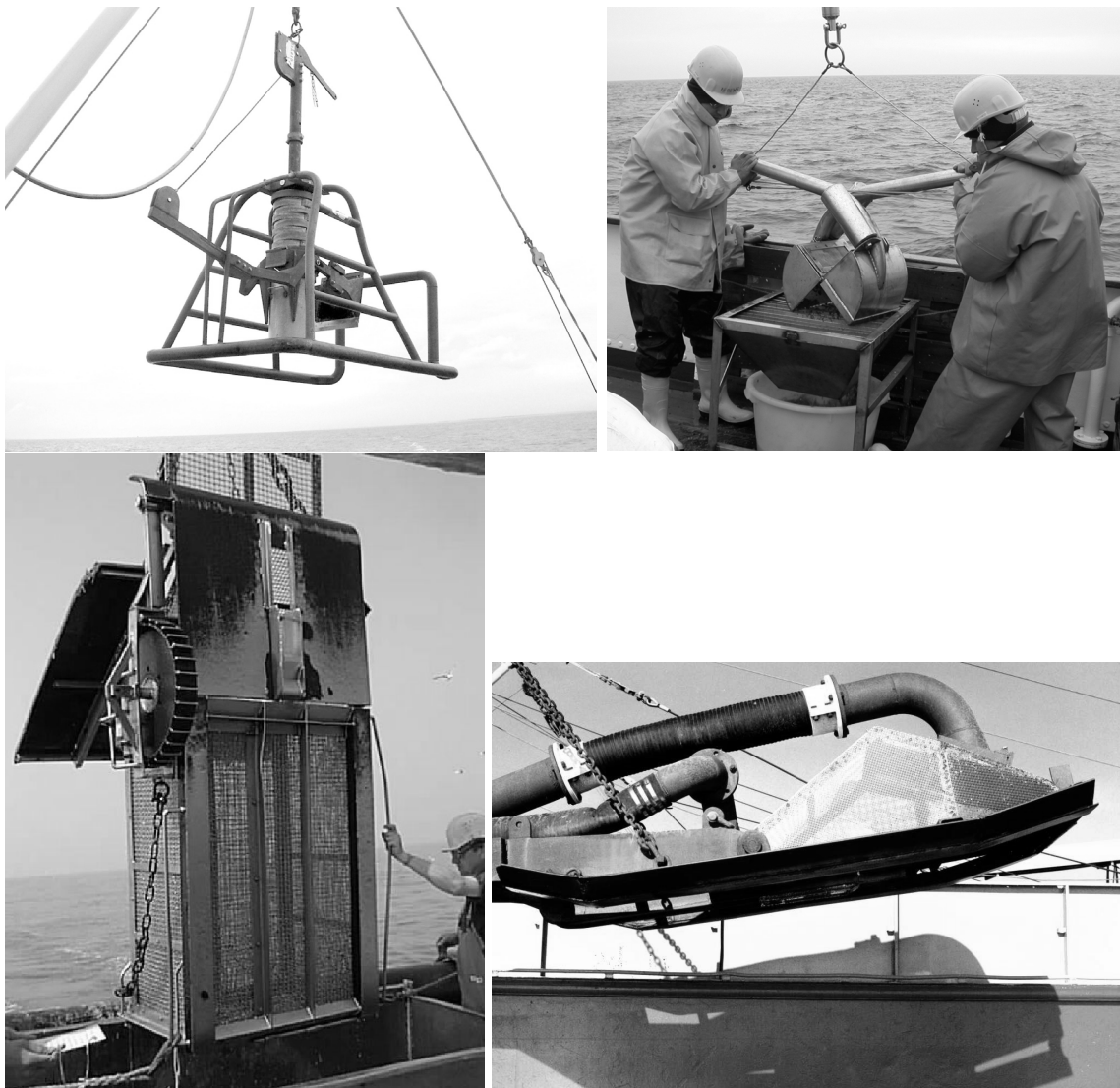
Fig. 1. Monstertuigen gebruikt bij onderzoek naar macrobenthos: box-corer (rechtsboven), Van Veen grijper (linksboven), bodemschaaf (linksonder) en hydraulische kor (rechtsonder).
