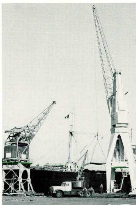
Schaalvergroting na W.O. II : twee elektrische topkranen aan het Leopolddok (Zuidkaai) in 1959. Links een M.A.N.-kraan uit 1928, 3 t x 6-18 m vlucht, toprol op 22-30 hoogte; rechts een Kocks-kraan uit 1958, 3 t tot 28 m en 5 t tot 20 m, toprolhoogte 41, 20-52, 50 m.
