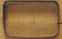
3° Corps de la boîte "monté" (dans les extrémités ont été soudés préalablement à l'aide d'un alliage d'étain et de plomb).
