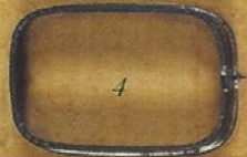
4° Première opération du "bordage" du corps de la boîte : les rebords en sont rabattus. L'un pour recevoir le couvercle et l'autre pour recevoir le fond.
