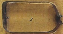
2° Corps de la boîte "équarri", prêt à être monté.
