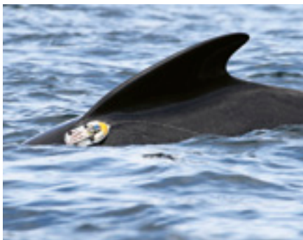
Figuur 3A: de DTAG-zender zoals met zuignappen geplaatst op een walvis, in het voorbeeld op een griend.
