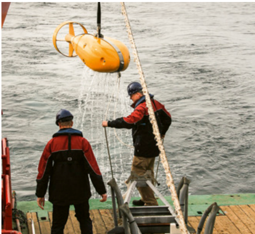
De geluidsbron SOCRATES is vergelijkbaar met de sonarbron die de marine gebruikt voor de detectie van onderzeeboten. Hiermee onderzoekt TNO onder meer het effect van actieve sonar op zeezoogdieren.
