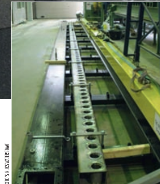
Plezierboten varen door het bellenscherm in de proefopstelling in de Stevinsluizen van de Afsluitdijk. De inzet toont de gebruikte installatie.
