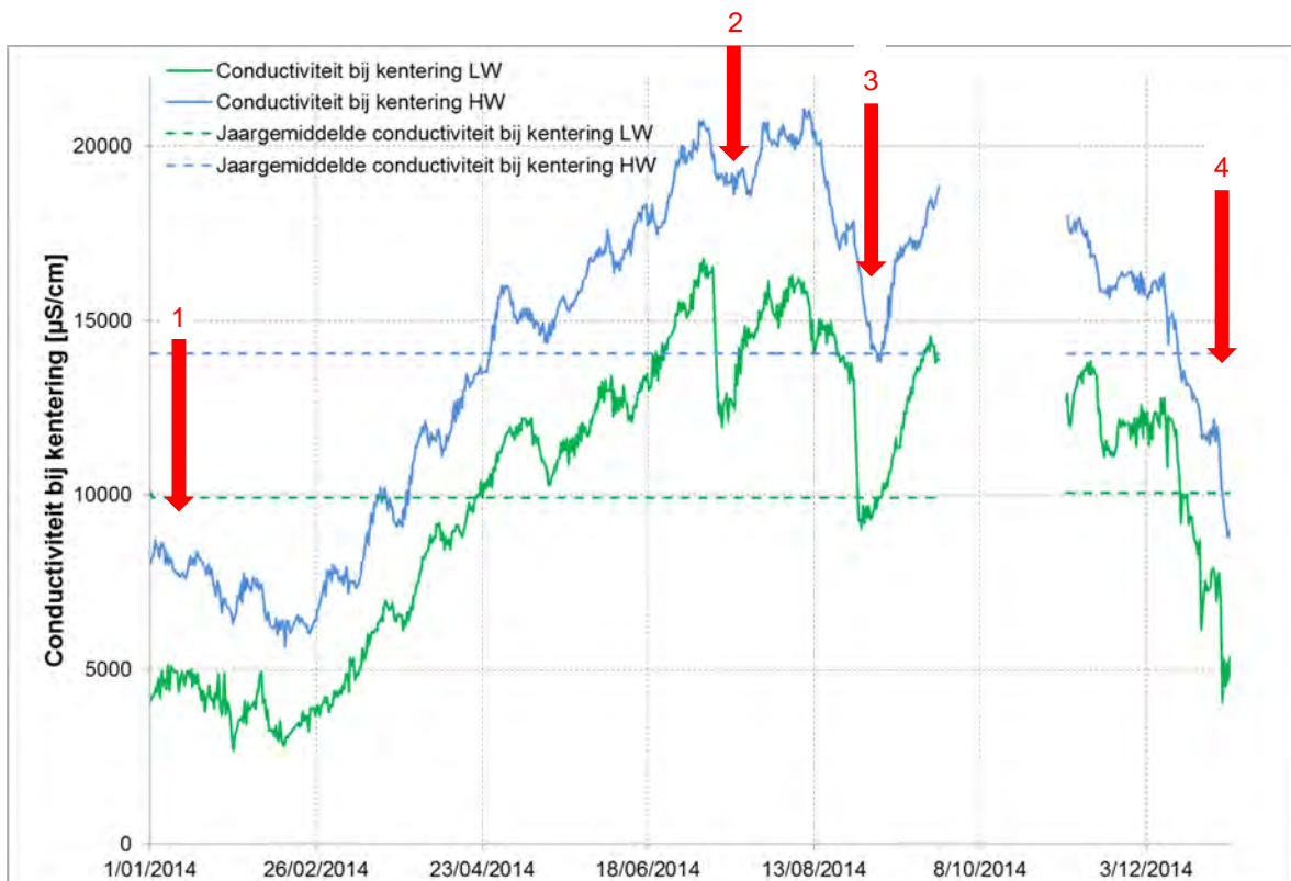
Figuur 80 - Conductiviteit bij KHW en KLW te Boei 84 (Beneden- Zeeschelde), bovenste meettoestel (2014)
