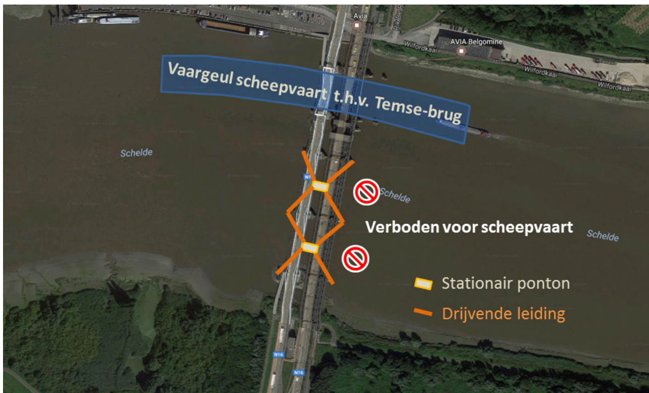
Figuur 13 – Potentiële (test)opstelling stationaire pontons met drijvende leiding ter hoogte van Temse-brug
