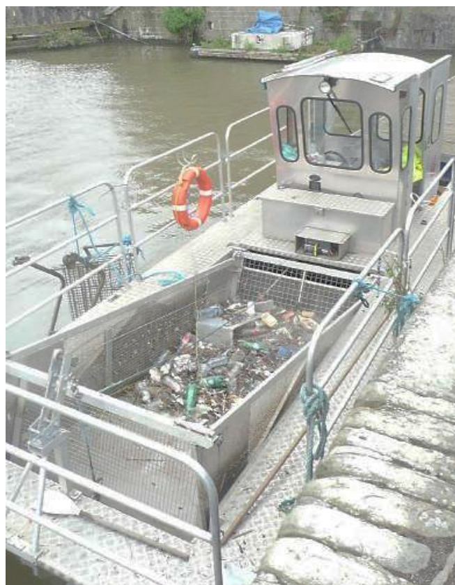
Figuur 5 –Catamaran met roostercontainer
