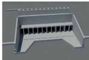
Afbeelding 6.14. De polderzijde van de in- en uitwateringsstructuur. Een aantal van die kokers dient enkel voor inwatering. De middelste kokers worden zowel voor inwatering als uitwatering gebruikt.
