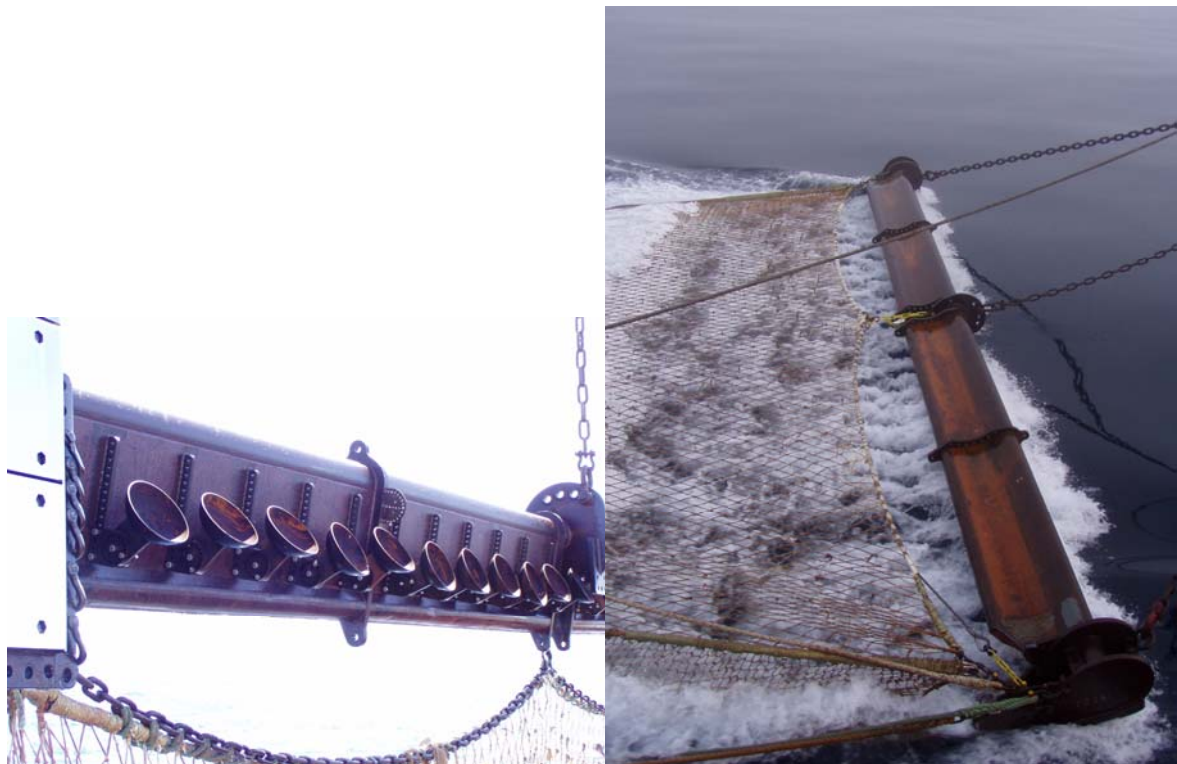
Figuur 3-12: Vierde versie HydroRig met bolkappen onder de vleugel uitgetest op de FD-281 in augustus 2009
