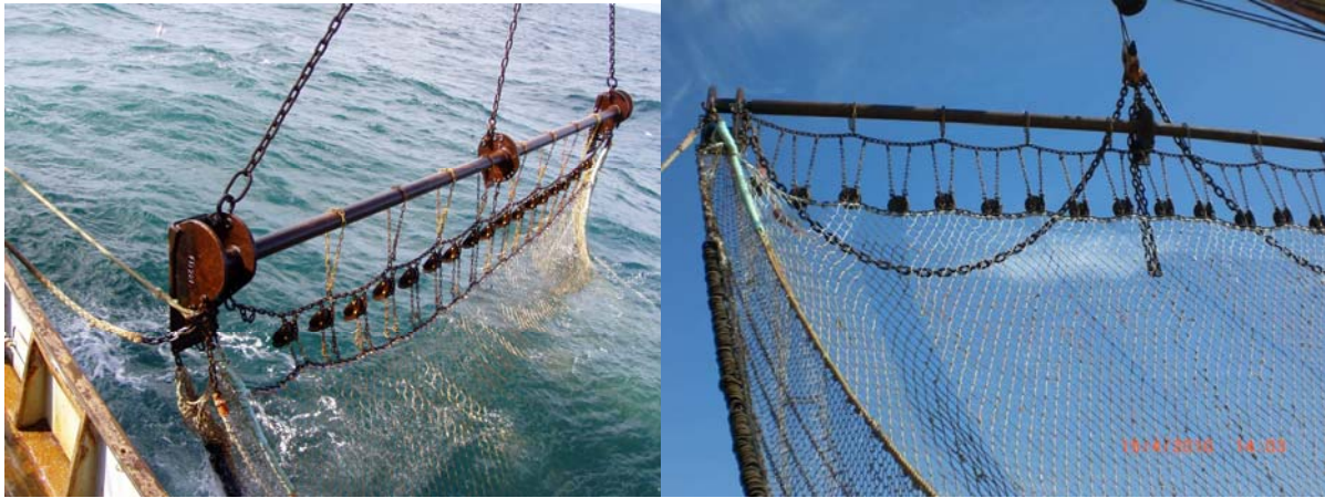
Figuur 3-14: Vijfde ontwerp HydroRig getest in april-mei 2010 (Bron: K.J. Koffeman, schipper FD-281)
