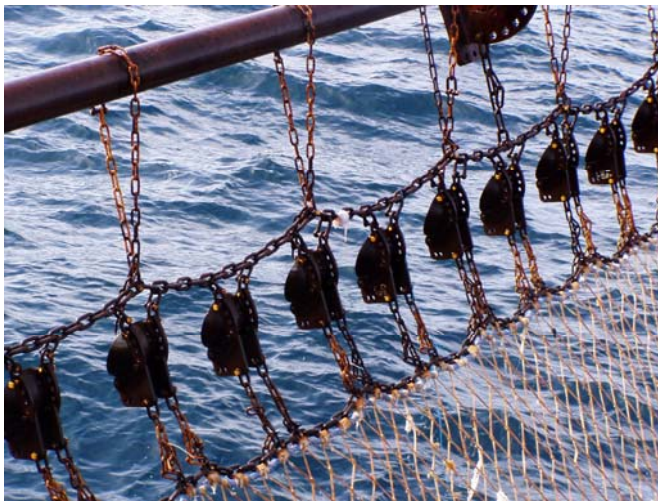
Figuur 3-15: Vijfde ontwerp HydroRig met zwaardere wangen (detail rechts) getest eind mei 2010 (Bron: K.J. Koffeman, schipper FD-281)
