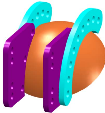
Figuur 3-15: Vijfde ontwerp HydroRig met zwaardere wangen (detail rechts) getest eind mei 2010 (Bron: K.J. Koffeman, schipper FD-281)
