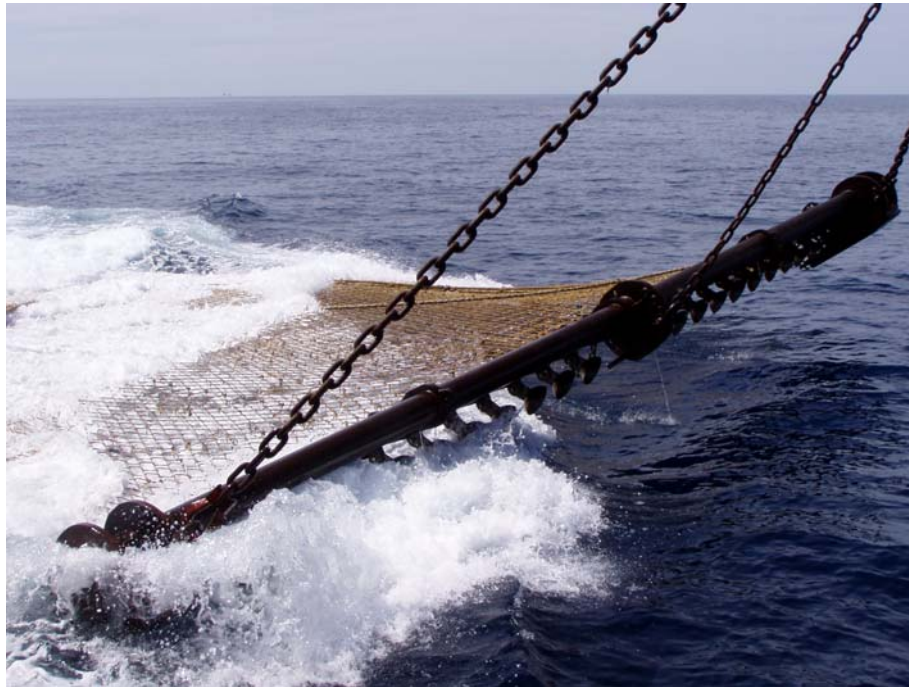
Figuur 3-10: Derde versie HydroRig met bolkappen onder de boom uitgetest op de FD-281 in juni-juli 2009
