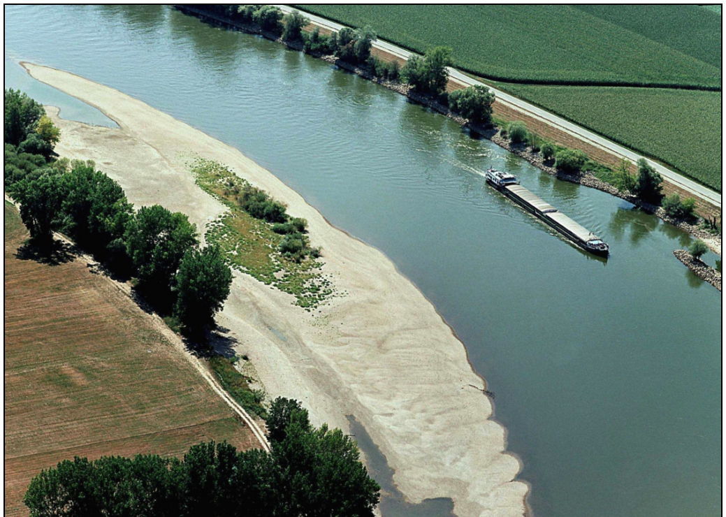
Versmalling door aanzanding in een binnenbocht van de Donau
