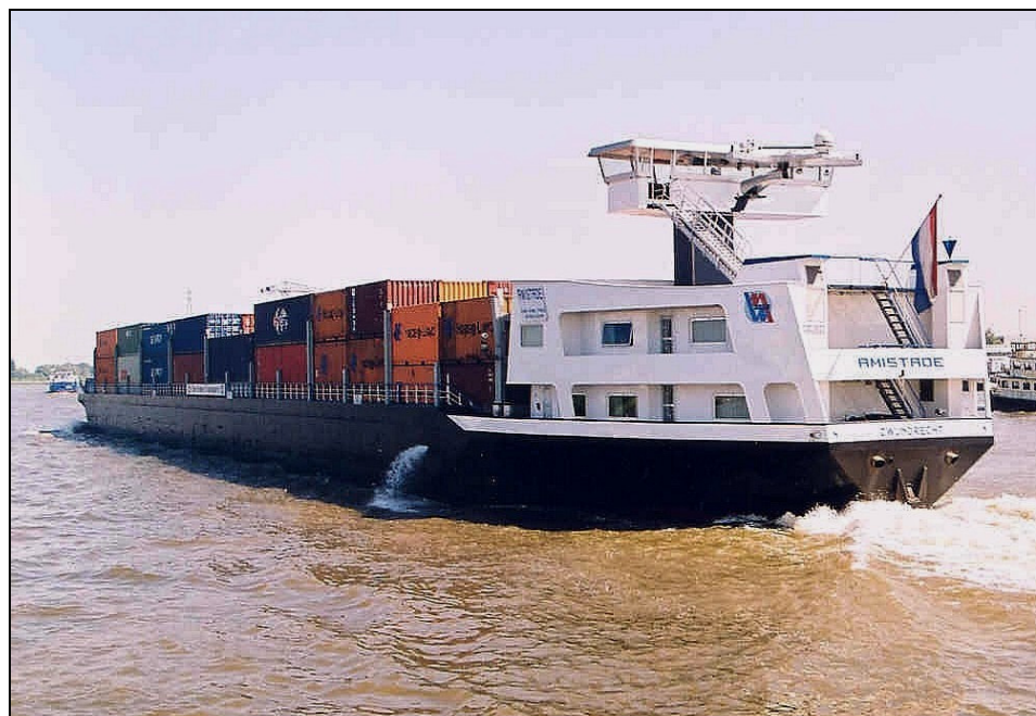
Containerschip klasse VIa (Jowi-klasse), capaciteit 398 TEU
