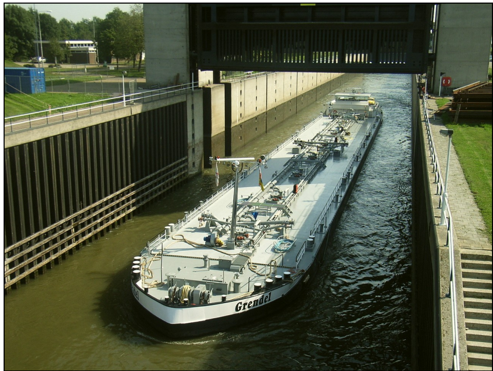
Klasse Va schip (110 x 11,4 m) het huidige standaardschip
