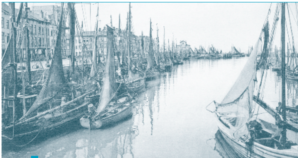
Het Schuuldok en de Visserskaai (omstreeks 1925). Het gebouwtje met puntdak op de achtergrond is de Reddingsdienst (ook wel de "permerensje" genoemd). Bemerkt de boomkorren op de reling van de vaartuigen op de voorgrond. De boomkor was het meest courante bodemvstuig op de zeilsloepen. Het is pas met de komst van de stoomtreilers dat bodemvstuig met planken of scheerborden zijn intrede deed (uitgave Albert, no. 150)
